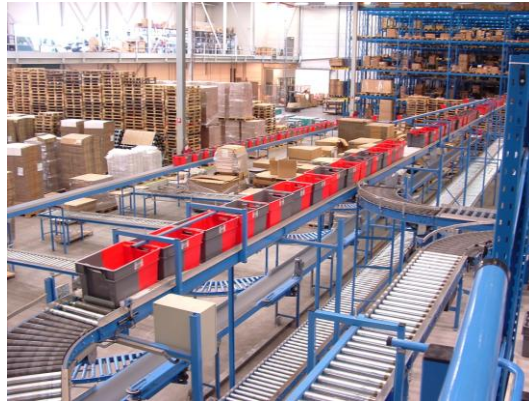
rollenbaan met scanning en locatiedetectie
