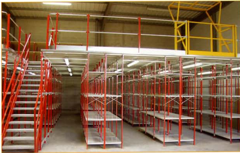
Etage-vloer op stelling met staalplaat legborden
