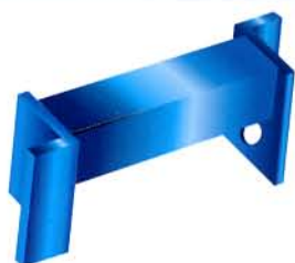
2 Afstandsstukken: kokerprofiel: 20x20x1 mm, om een bepaalde afstand tussen 2 jukken te fixeren, lengte van 100 tot 1.250 mm. Standaard kleur: RAL 5015.
